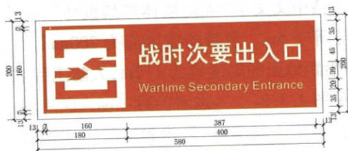
图 4.4.2 口部标识牌样式及尺寸示例(图中单位为毫米)
