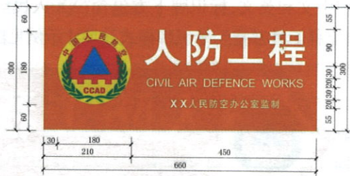
图 4.2.2 标志标识牌样式及尺寸示例(图中单位为毫米)
